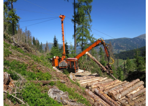
Holzarbeit mit Seilkran und Prozessor, Sommer 2023
